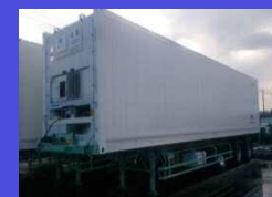
12m 冷凍コンテナ
